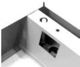
rys. 4 - gwintowany trzpień regulacyjny stopki umożliwiający poziomowanie szafy zainstalowany w cokole
